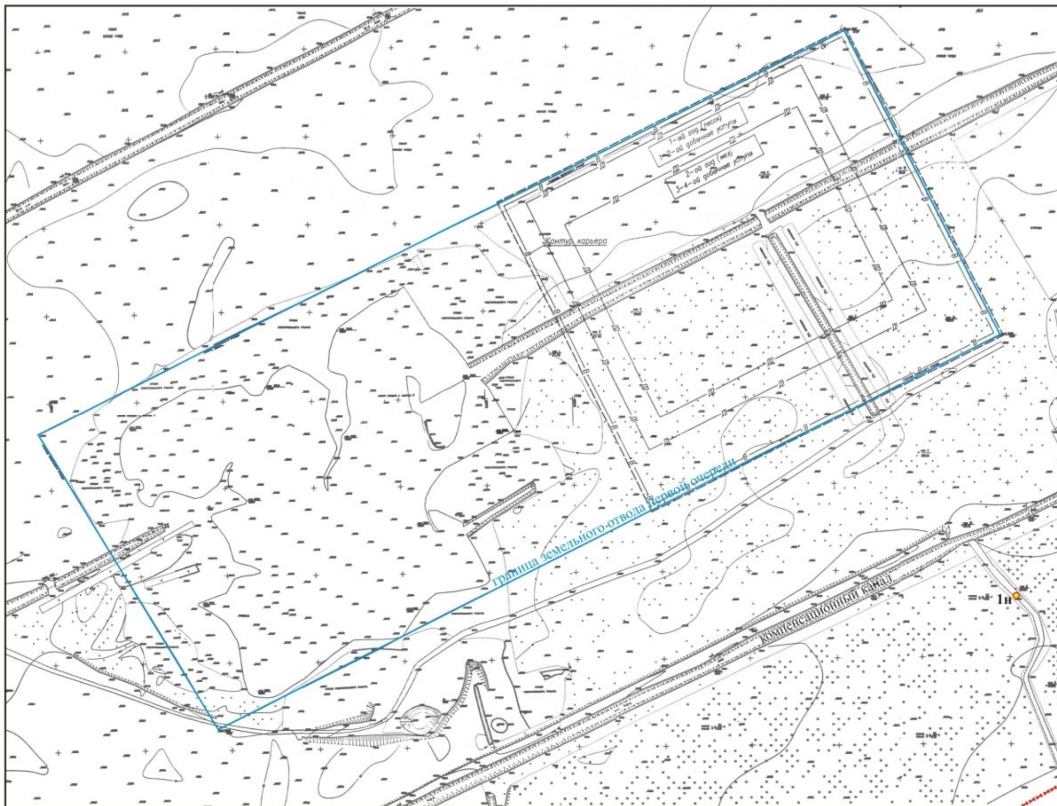
Рисунок 1.2 - План добычных работ I очереди отработки месторождения "Хотиславское". Масштаб 1:2300
