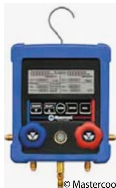
Рисунок 17. Набор электронных манометров для работы с горючими хладагентами, R-717 и хладагентами под высоким давлением (до 50 бар)
