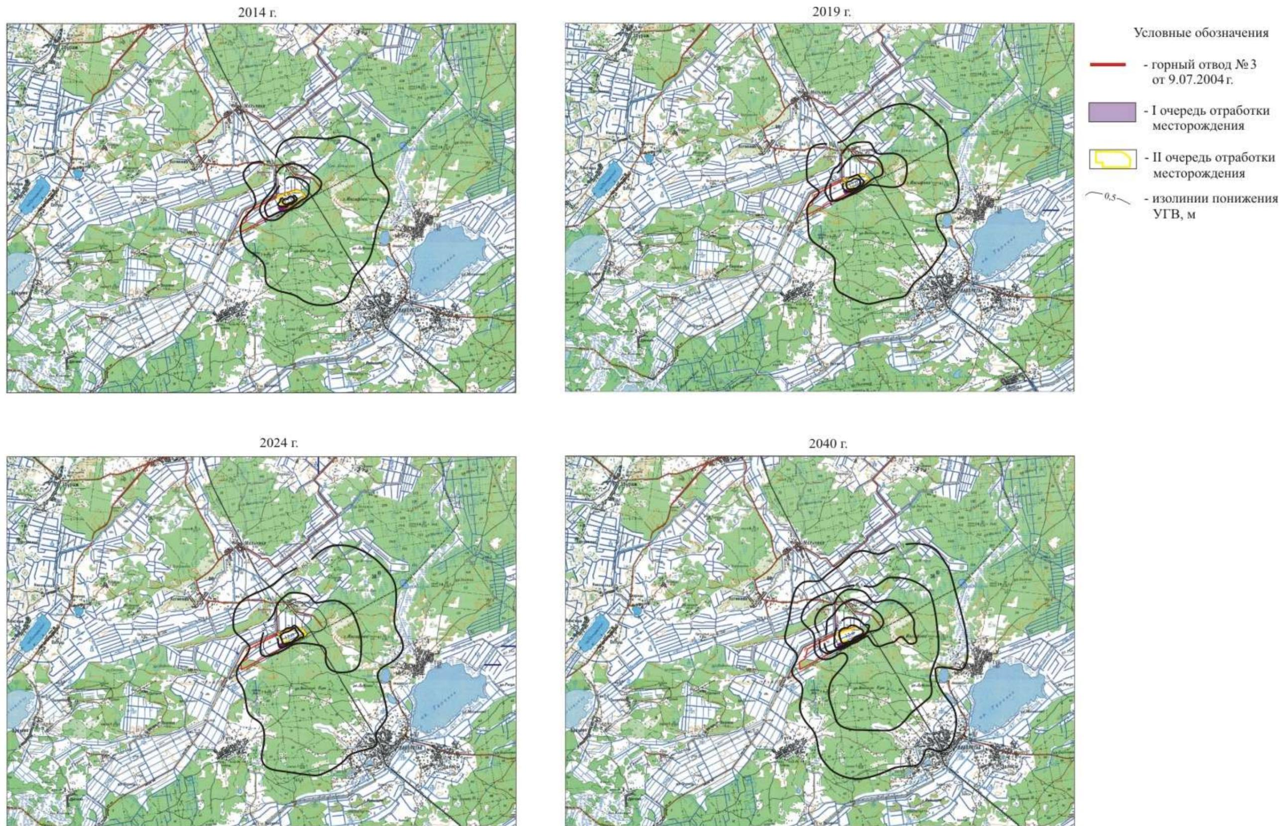
Рисунок 5.6 - Прогнозное понижение уровня грунтовых вод при эксплуатации II очереди месторождения "Хотиславское" на период с 2014-2040 гг. с применением двух компенсационных каналов. Масштаб 1:200000
