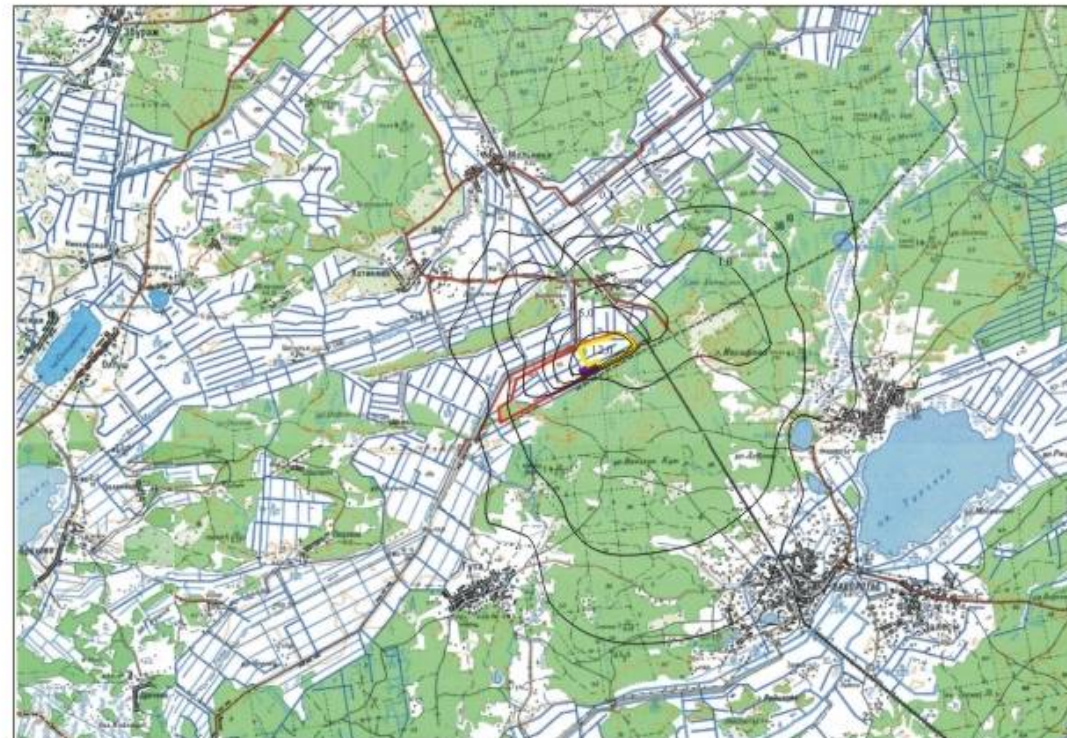
Рисунок 6.3 - Прогнозное понижение уровня грунтовых вод при эксплуатации II очереди месторождения "Хотиславское" на период с 2014-2040 гг. с применением двух компенсационных каналов и альтернативной отработки карьера. Масштаб 1:200000
