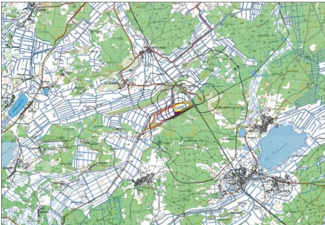
Рисунок 6.3 - Прогнозное понижение уровня грунтовых вод при эксплуатации II очереди месторождения "Хотиславское" на период с 2014-2040 гг. с применением двух компенсационных каналов и альтернативной отработки карьера. Масштаб 1:200000
